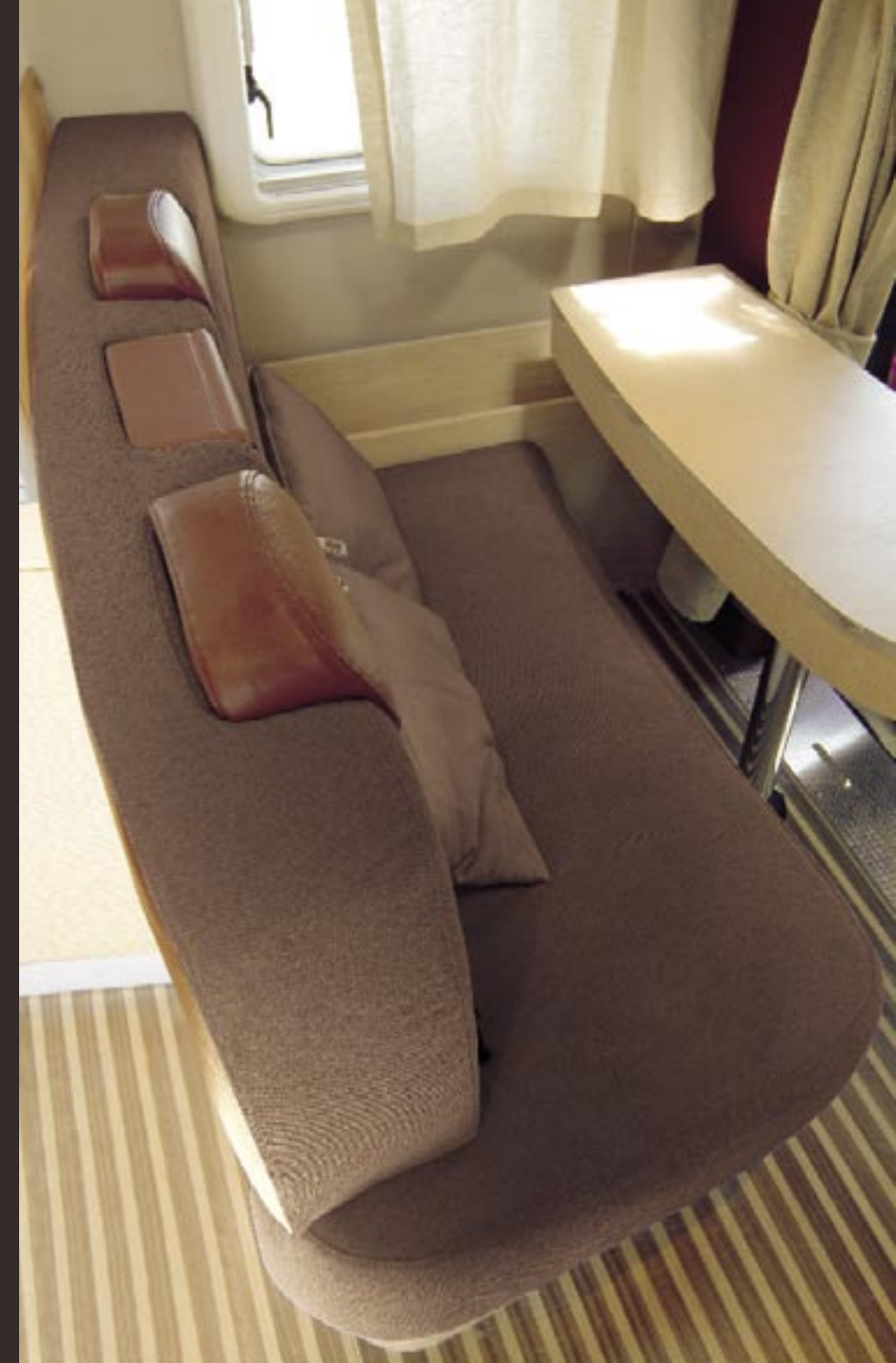
Grande divano con rivestimento misto tessuto/ecopelle, poggiatesta integrati regolabili in altezza. Albero cinture telescopico a scomparsa (GSBS - Giottiline Safety Belt System).
